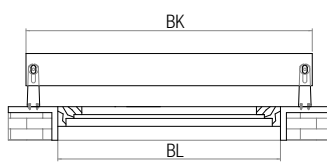
Guide oltre luce fissate frontalmente con distanziali Cable guides with frontal fixation through specific holders for cables
