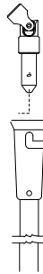
ASTA SGANCIABILE A BAIONETTA collegata allo snodo con possibilità di sgancio ad incastro. DETACHABLE HANDLE WITH BAYONET CONNECTION, with sliding clutch
